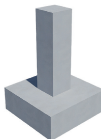
Stütze mit angefertigtem Fuß
