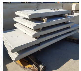
Foto 2: Bauteile mit R-Beton: Konsistenz des Betons, Verarbeitbarkeit und Oberflächen sehr gut
